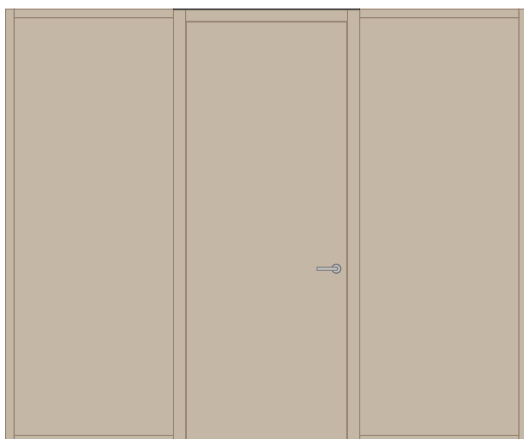
Holztrennwand mit Holztüre und Vollwand
